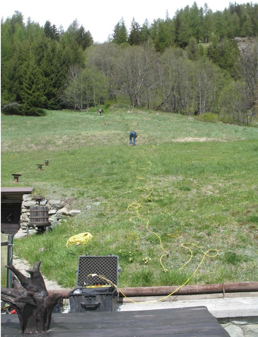
**Figura 4 - “Layout” dei profili di tomografia elettrica**
