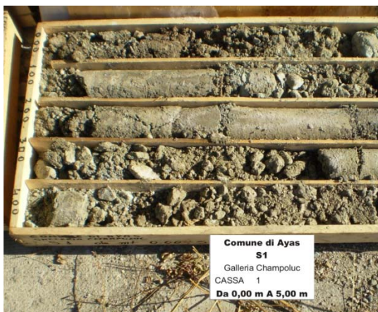
Fig 6.1 Sondaggio S1 – Ubicazione del punto di indagine ed immagine delle carote recuperate
