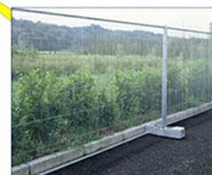
Recinzione provvisoria modulare da cantiere in pannelli di mm 2000 x 3500 con tamponatura in rete elettrosaldata, con maglie mm 300 x 100, tubolare verticale di diametro mm 41,5 e orizzontale di diametro mm 30, su blocchi di supporto in calcestruzzo e giunti di ancoraggio.
